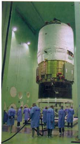
L'ATV Jules Verne dans la chambre acoustique de l'ESTEC.
